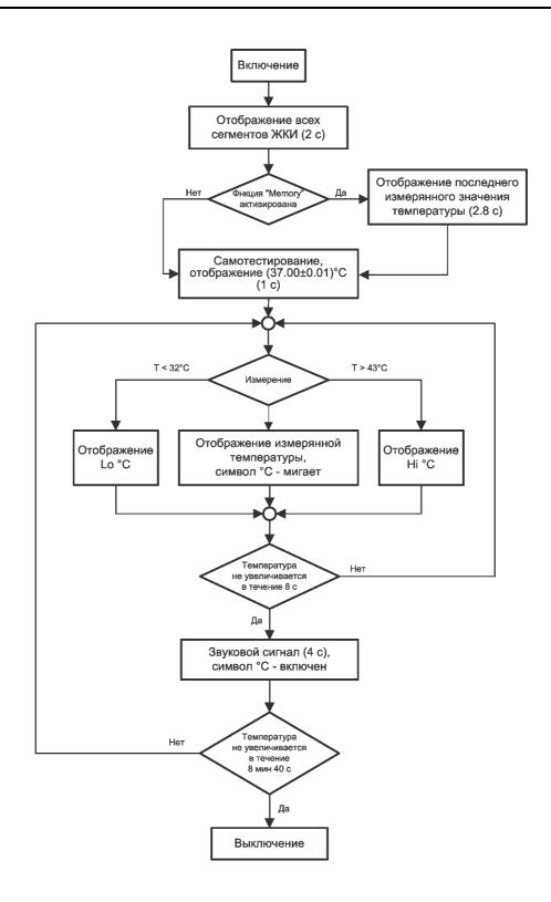
Термометр всегда показывает максимальную измеренную температуру — т.н. режим «максимометра». Если измерянная температура меньше 32°C, то на ЖКИ отображаются символы « Lo°C », если больше 43°C — отображается « Hi°C».
