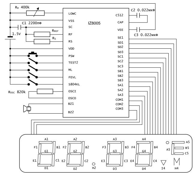
$R_{\text{S}}$  – терморезистор 503ET ф. "Semitec"
