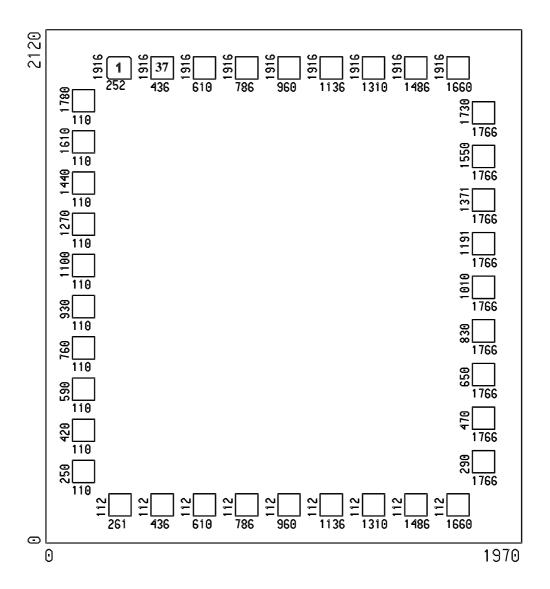
Размер кристалла: 1.97 x 2.12 mm Подложка кристалла должна быть соединена с цепью VDD.
