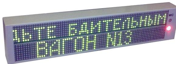
ТИС устанавливается внутри вагонов поезда, состоит из двух информационных строк: верхней и нижней, и двух индикаторов занятости туалета. Верхняя строка предназначена для отображения в режиме «бегущая строка» информации о маршруте следования поезда, о станции назначения и станции следования и другой дополнительной информации для пассажиров, включая рекламную информацию. На нижней строке попеременно отображается следующая информация:
