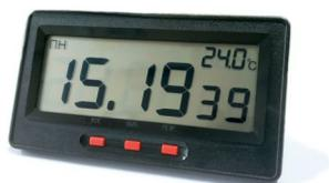
Часы электронные настольные «Интеграл ЧЭ-08» - электронный прибор с автономным источником питания и жидкокристаллическим индикатором (ЖКИ). Принцип работы часов электронных настольных основан на использовании кварцевого генератора и микропроцессора, обеспечивающего работу прибора во всех режимах и вывод информации на ЖКИ. Напряжение питания 1,5 В обеспечивается одним элементом питания типа LR6.
