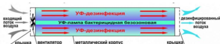
Очиститель воздуха ультрафиолетовый предназначен для очистки воздуха в офисных, производственных, складских, общественных помещениях в присутствии людей.
