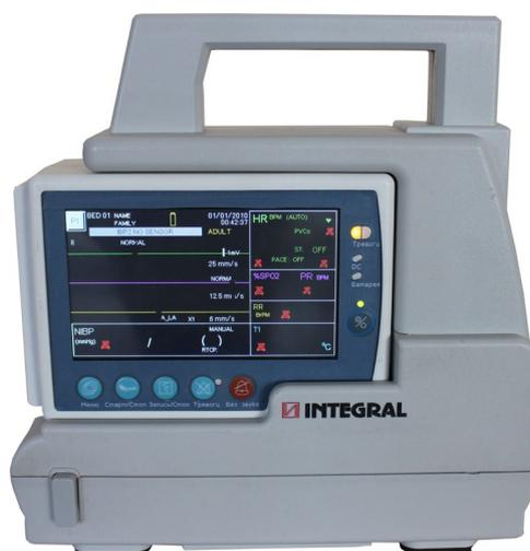
Монитор портативный пациента (МПП) предназначен для измерения, непрерывного отображения и анализа параметров физиологического состояния пациентов (взрослых и детей, в т. ч. новорожденных) в реальном масштабе времени, обработки и накопления результатов измерений.
