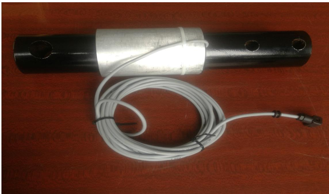
Датчик тензоэлектрический (далее – тензодатчик) предназначен для преобразования сигнала нагрузки в электрический сигнал.
