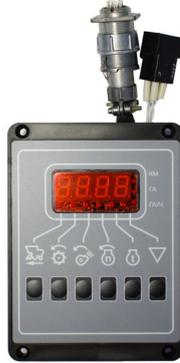
Предназначен для работы в составе комплектов электронных блоков автоматизированной системы контроля технологических режимов работы комбайна.
