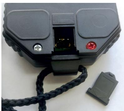
В секундомерах электронных "Интеграл С-01" имеется возможность управления по внешним электрическим цепям. Цепи кнопок «СТАРТ/СТОП», «СБРОС», а также «+Е» питания выведены на разъём, находящийся под крышкой люка в задней крышке корпуса прибора. В качестве разъёма на плате секундомера используется разъём-вилка PLS2-3. В комплект изделия входит разъём-розетка BLS2-3.
