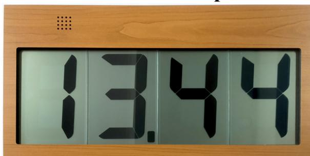
Часы настенные электронные «ИНТЕГРАЛ ЧЭ-03»-Д отображают информацию на четырехразрядном цифровом жидкокристаллическом индикаторе. Корпус часов выполнен из ламинированной древесностружечной плиты (ЛДСП). Напряжение питания 3 В обеспечивается двумя элементами питания типа R20, включенными последовательно.
