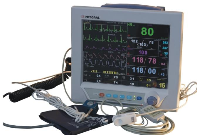
Монитор предназначен для измерения и оценки жизненно важных физиологических параметров пациентов (взрослых и детей), обработки, хранения и передачи в реальном масштабе времени информации о состоянии функций организма.
