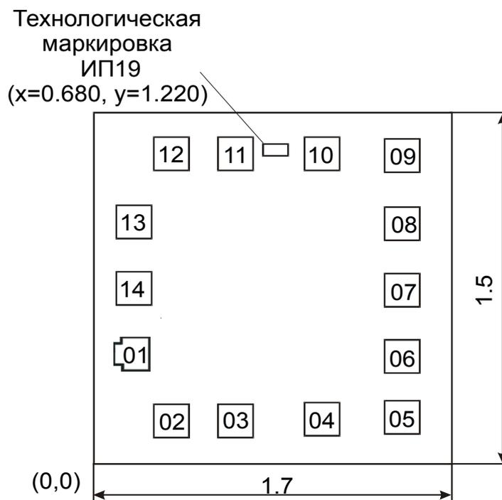
Размер контактных площадок 0.140 x 0.140 мм (Размер указан по слою "металлизация")
